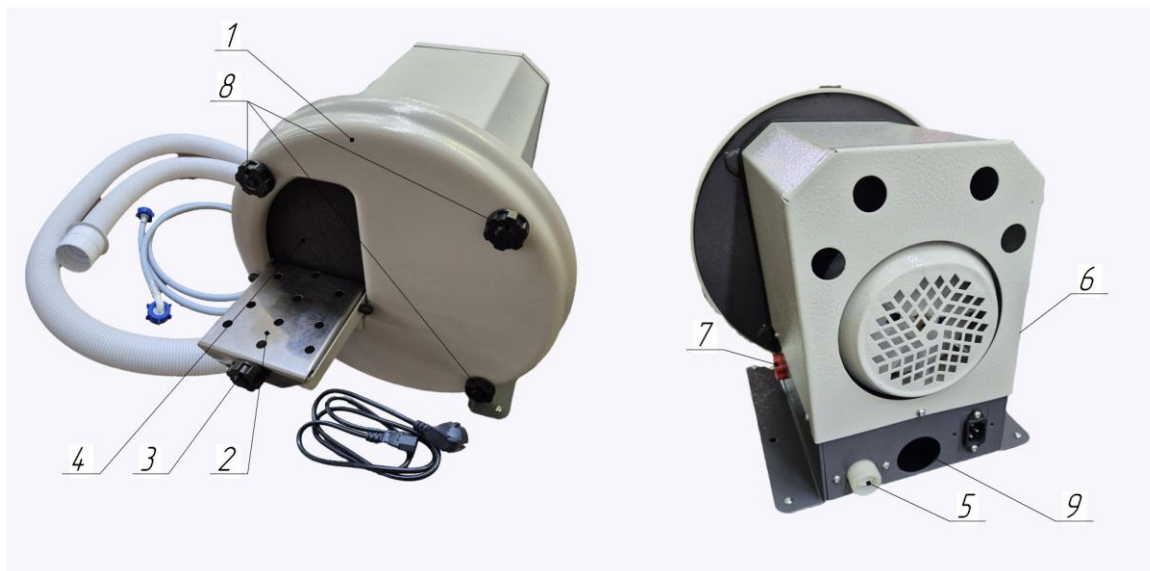
Рис.1: 1-кожух; 2-столик; 3-регулирующий винт; 4 - абразивный круг; 5 - электроклапан; 6 - выключатель; 7 - регулировочный вентиль; 8 - винты кожуха; 9 сливной штуцер.
